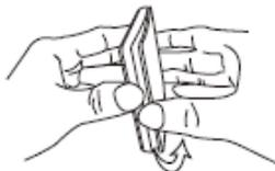
1-1 Trenne die Schalteinheit von der Grundplatte.
